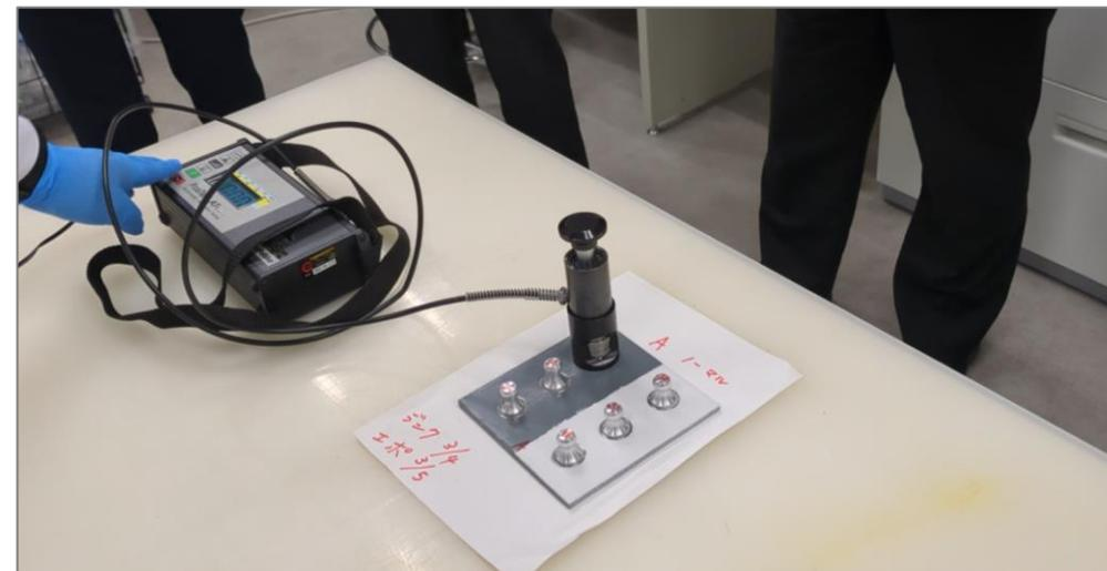
写真 アドヒージョン試験の様子
