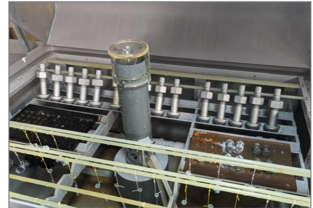
写真 耐塩水噴霧性試験の様子
