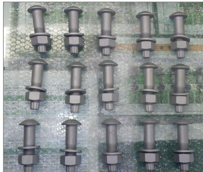
写真 防錆処理後の高力ボルト
