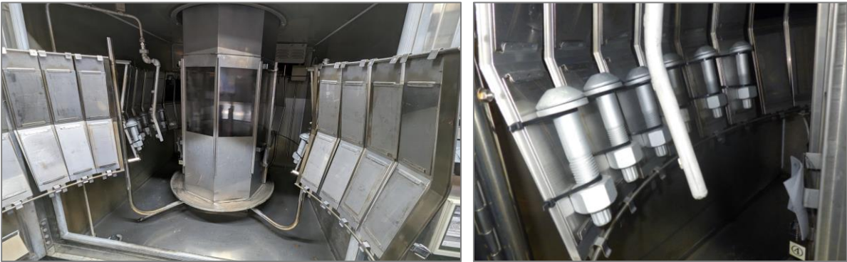
写真 促進耐候性試験の様子
