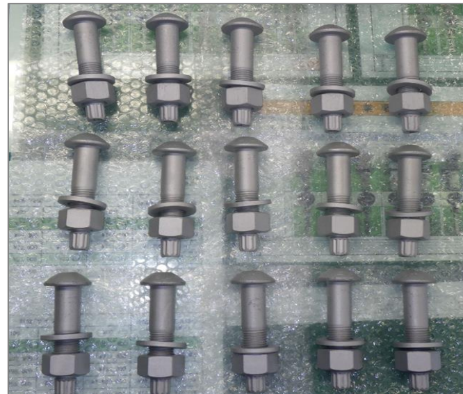
写真 防錆処理後の高力ボルト
