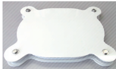
GFRP製マンホール蓋の接着接合
